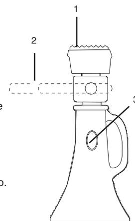
Per azionare la barra di leva illustrata in (2), introdurla nel foro prescelto della testa a 4 vie del martinetto. Accertarsi che la barra di leva sia inserita nel foro per tutta la sua lunghezza. Afferrare la barra di leva con decisione ed esercitando una forza controllata, girare la vite in senso orario per estendere od antiorario per ritrarre la vite, spostando la barra nel foro adiacente dopo una rotazione completa della vite.
