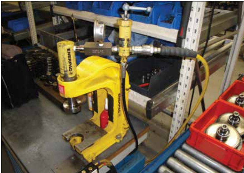
▲ Cilindro RC-308 montado en una prensa de husillo A-330 accionada por una bomba hidroneumática Turbo PATG para realizar una extracción controlada de rodamientos en ruedas dentadas de telares. La válvula V-152 controla la presión de la operación.
