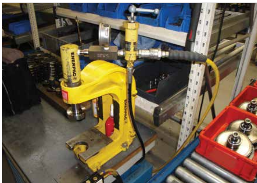
▲ Cilindro RC-308 montado numa prensa de bancada modelo A-330 acionada por uma bomba hidro-pneumática PATG Turbo II para realizar a prensagem controlada de rolamentos montados em rodas dentadas de máquinas de tecelagem. A válvula de alívio de pressão modelo V-152 permite controlar a força de prensagem.
