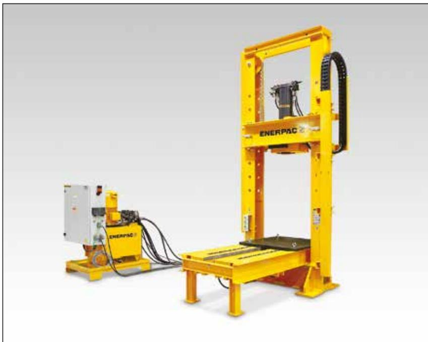
▲ Per le applicazioni offshore è stato necessario assemblare e testare cilindri caricati a molla ad alta capacità. Sono stati costruiti una speciale pressa con telaio a rulli da 100 tonnellate e un cilindro con una lunga corsa. Tutti i movimenti sono eseguiti e monitorati tramite una pulsantiera controllata da PLC.
