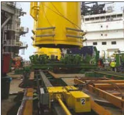
▼ *Carro eléctrico de la serie ETR sometido a pruebas de aceptación en fábrica antes del envío.*
