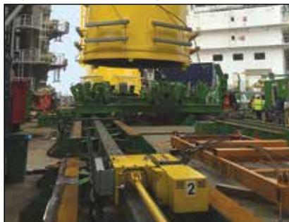
▼ Carro de rodadura eléctrico de la serie ETR sometido a pruebas de aceptación en la fábrica antes de su envío.
