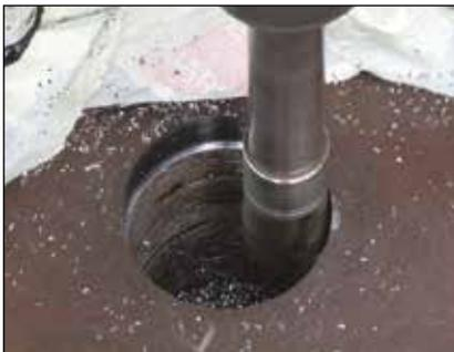
▲ Ampliación de un orificio
