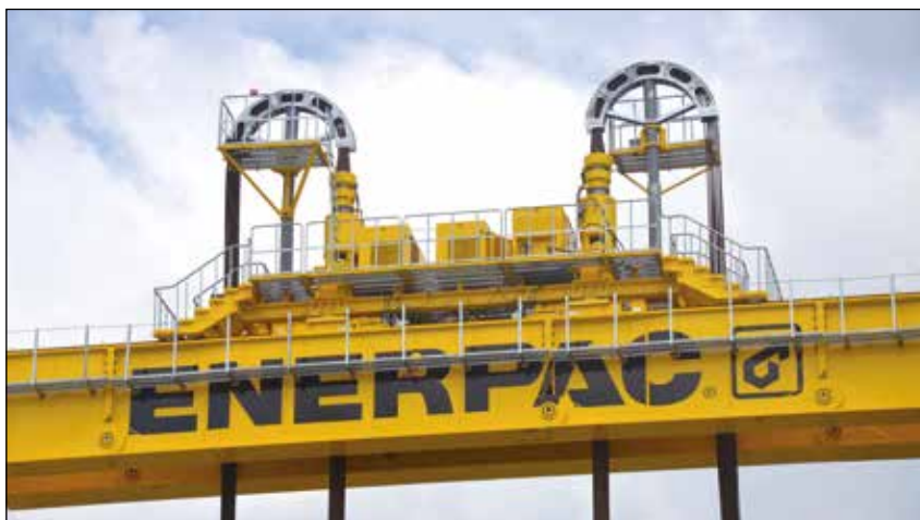
◀ Sistema de levantamento multicabos HSL85007 usado na torre automotante personalizada da Enerpac.
