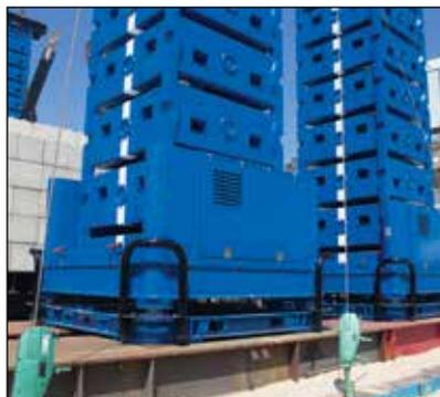
▼ *O Sistema de Levantamento Enerpac suspende o vão de 1.500 ton. na Ponte Fore River.*
