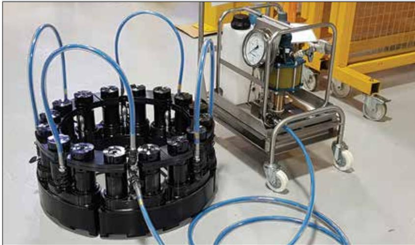
▲ Configuração de tensionamento de parafusos múltiplos
