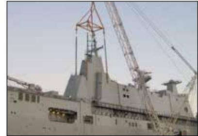
Içamento sincronizado e posicionamento de carga
