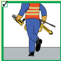
◀ Não levante o equipamento hidráulico pelas mangueiras.
