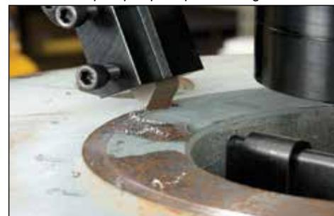
A linha de ferramentas patenteadas de separação de flanges da Equalizer™ foi desenvolvida para auxiliar e simplificar a manutenção de juntas flangeadas. Os operadores encarregados de separar os flanges não precisarão mais usar cordas e polias, chaves, guinchos, aparas ou martelos, pois existe uma alternativa segura, rápida e eficaz:
