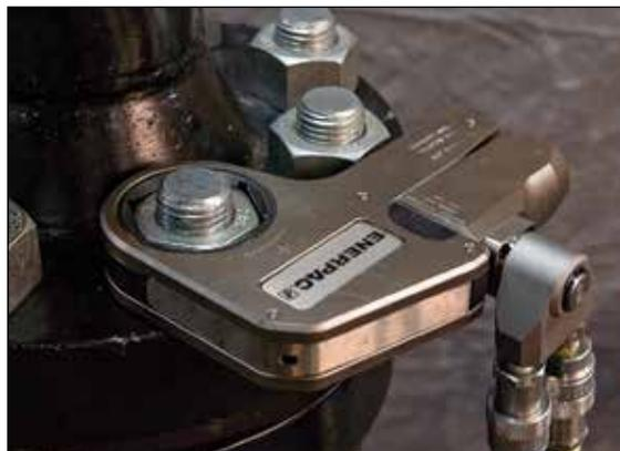
◀ Qualquer marca de chave de torque pode ser acionada com a bomba portátil da Série ZU4T.
