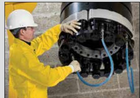
▲ Aplicação de tensionamento de parafusos múltiplos.
