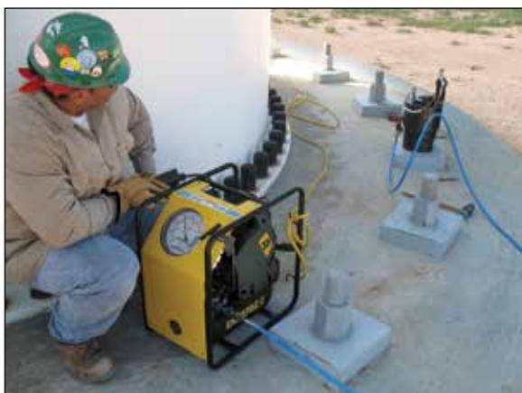
◀ *Trabalhando com um gerador em locais remotos, a confiável Enerpac ZUTP1500 proporciona a super alta pressão necessária para aplicações de tensionamento.*
