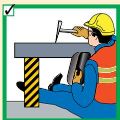
◀ Nunca coloque qualquer parte do seu corpo debaixo da carga. Certifique-se de que a carga está assentada em um apoio firme, antes de se aventurar debaixo da mesma.
