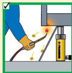
◀ Mantenha o equipamento hidráulico longe de chamas e de temperaturas acima de 65 °C (150 °F).
