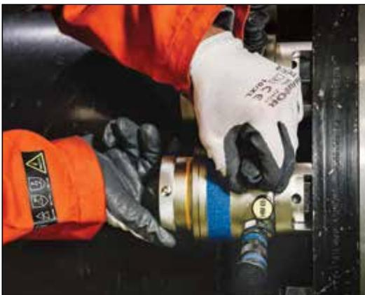
◀ Os tensionadores HydraMax® da Série HM da Enerpac foram projetados para gerar grandes cargas de parafusos, associadas a flanges compactos, proporcionando versatilidade para a máxima cobertura dos parafusos.
