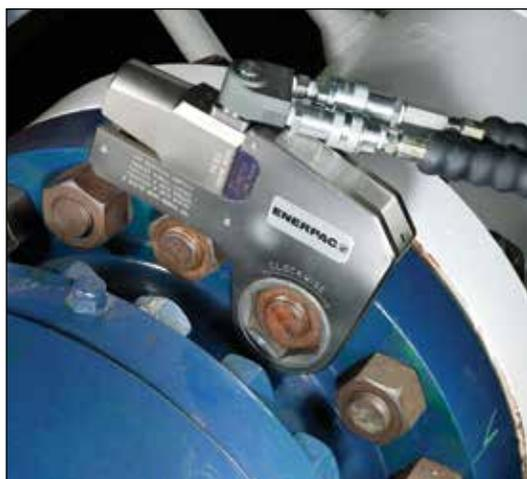
◀ A bomba ZE4T para torque se adapta perfeitamente a esta chave de torque W200X.
