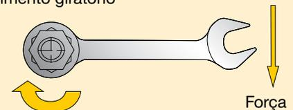
Tensão do fixador (Pré carga)
