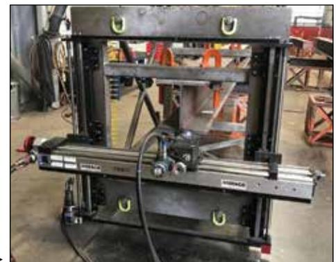
Fresamento de faces de viga "I" com uma GMRF1000. ▶
