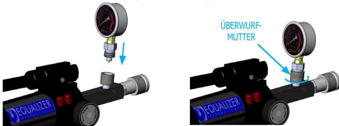
2. Stellen Sie sicher, dass das Hydrauliksystem, das Sie mit Druck beaufschlagen möchten, entlüftet wurde und frei von Luft und Leckagen ist. Schließen Sie die Pumpe mit der im Lieferumfang enthaltenen Schraubkupplung an das System an, schieben Sie den Kupplungsstecker und die Kupplungsmuffe vollständig zusammen und drehen Sie die Überwurfmutter im Uhrzeigersinn, bis sie fest sitzt.
