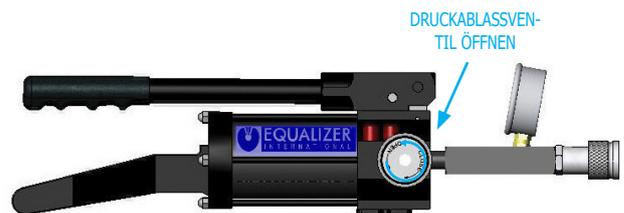
6. Wenn das System vollständig drucklos ist, kann die Pumpe durch Abschrauben der Kupplungen getrennt werden.
