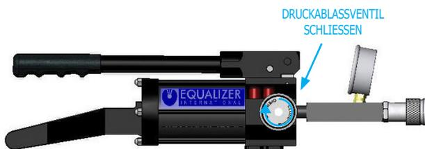
Der Pumpenhebel wird angehoben, wodurch ein Vakuum in der Kolbenkammer entsteht, das Öl aus dem Tank in die Kammer ansaugt.
