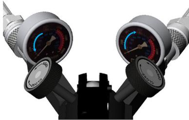
6. Wenn beide Systeme vollständig drucklos sind, kann die Pumpe durch Abschrauben der Kupplungen getrennt werden.
