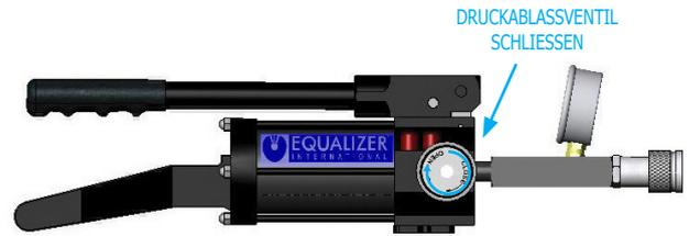
4. Beaufschlagen Sie das System mit Druck, indem Sie den Pumpenhebel anheben und niederdrücken, bis der gewünschte Druck auf dem Manometer angezeigt wird. N.B. max. Druck 700 bar (10.000 psi).
