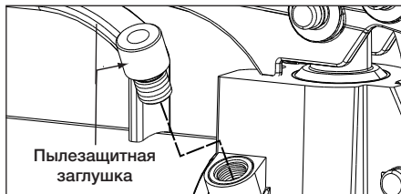
Рисунок 13 – предохранительный клапан (P-77, P-80, P-801 и P-84).
