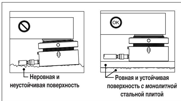
Рис. 4. Опора корпуса цилиндра
