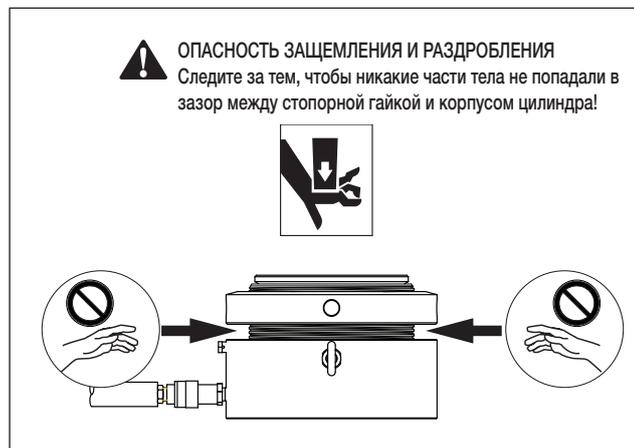
Рис. 1. Опасность защемления и раздробления
