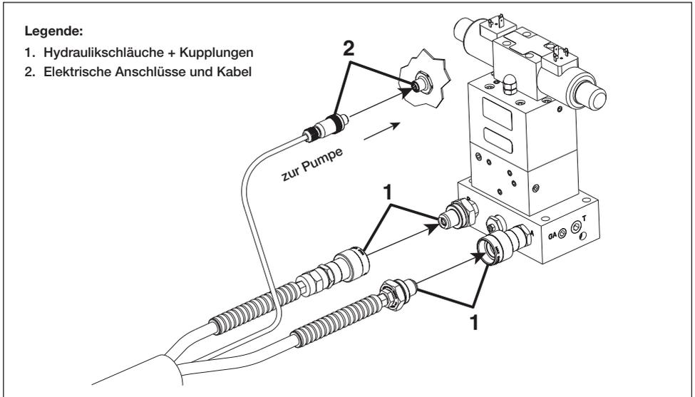
Abbildung 3, Hydraulik- und Elektroanschlüsse an der Pumpe
