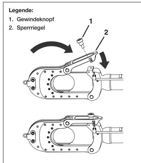
Abbildung 5, Schneidkopf schließen
