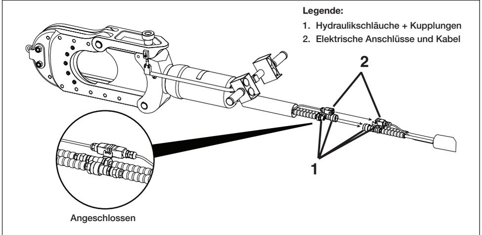
Abbildung 2, Hydraulik- und Elektroanschlüsse am Schneidgerät
