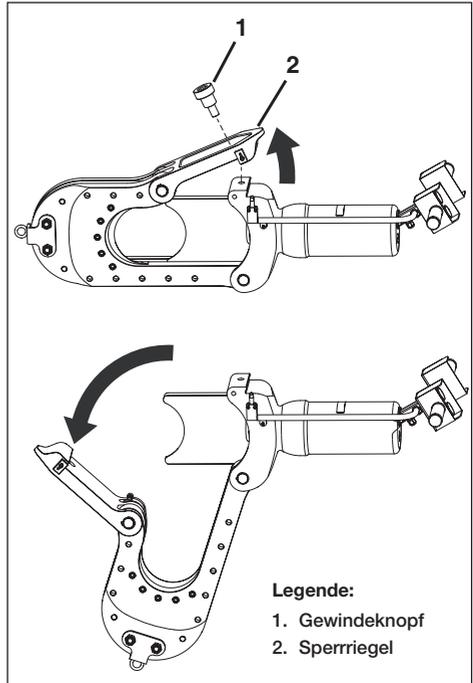
Abbildung 4, Schneidkopf öffnen
