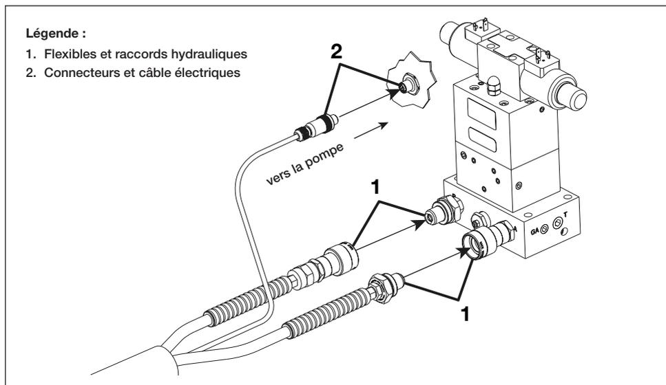
Figure 3, Branchements hydrauliques et électriques à la pompe
