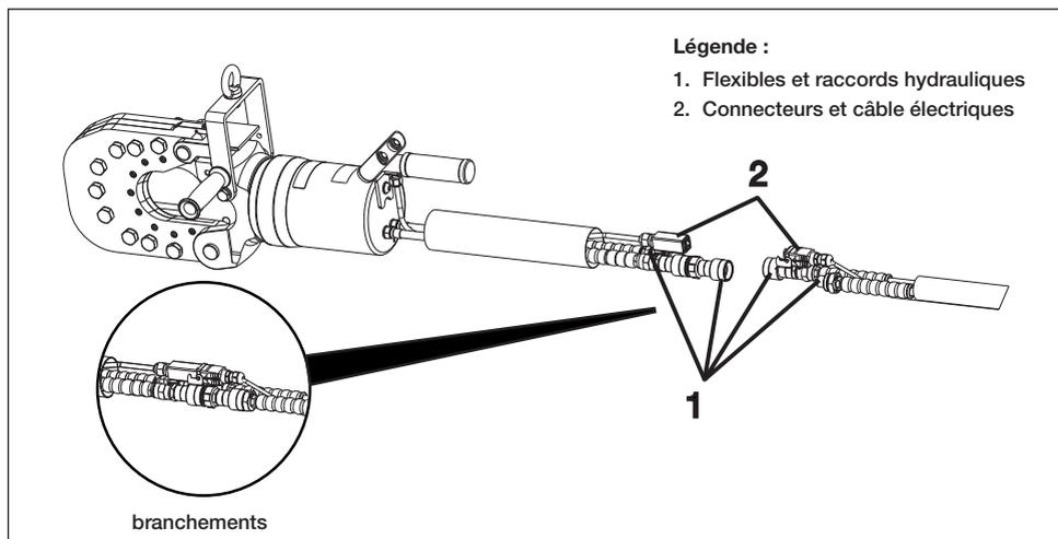
Figure 2, Branchements hydrauliques et électriques à la cisaille
