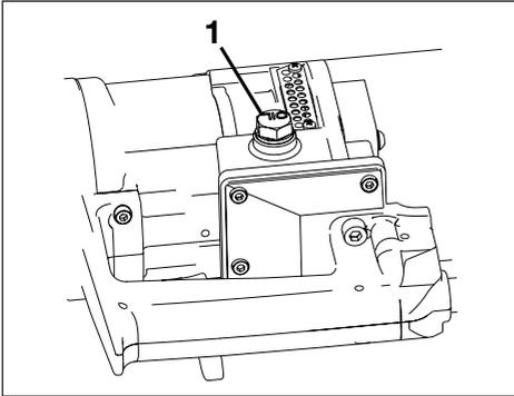
Figura 8A, Tapón del depósito de aceite (1)
