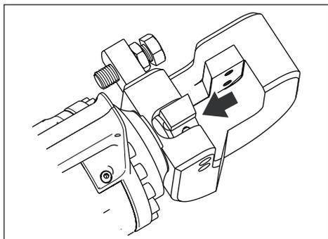
**Figura 4, Pistón y cuchilla completamente retraídos
