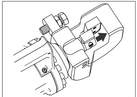
Figura 3, Pistón y cuchilla completamente avanzados
