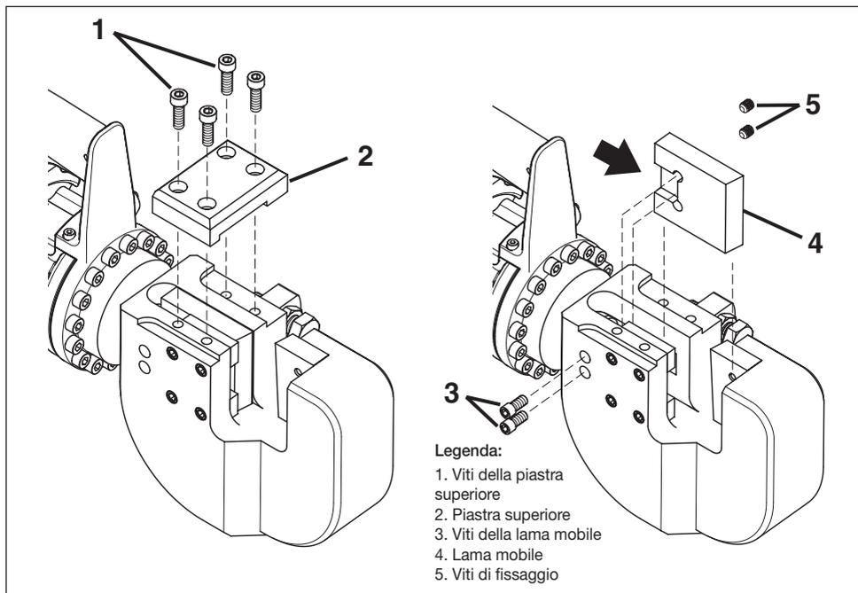
**Figura 10, Sostituzione della lama mobile**
