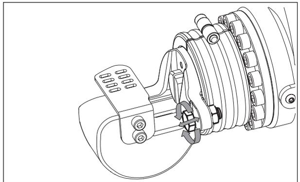
Abbildung 8, Einstellung des Stützbolzens
