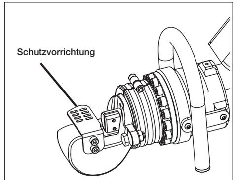
**Abbildung 4, Schutzvorrichtung**
