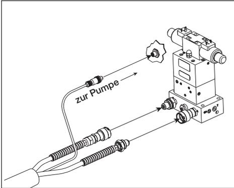
**Abbildung 3, Hydraulik- und Elektroanschlüsse an der Pumpe**
