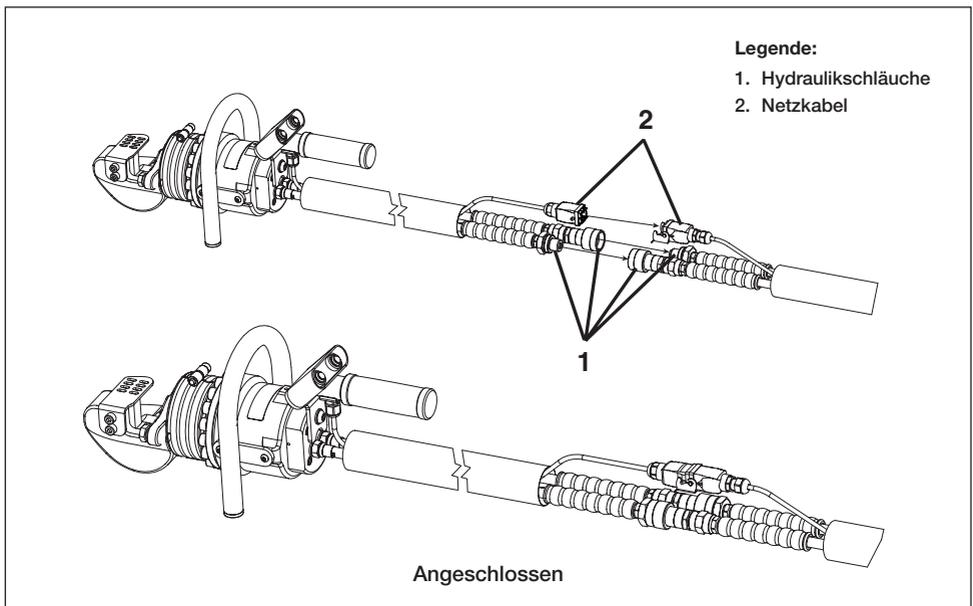
Abbildung 2, Hydraulik- und Elektroanschlüsse am Schneidgerät (typisch)
