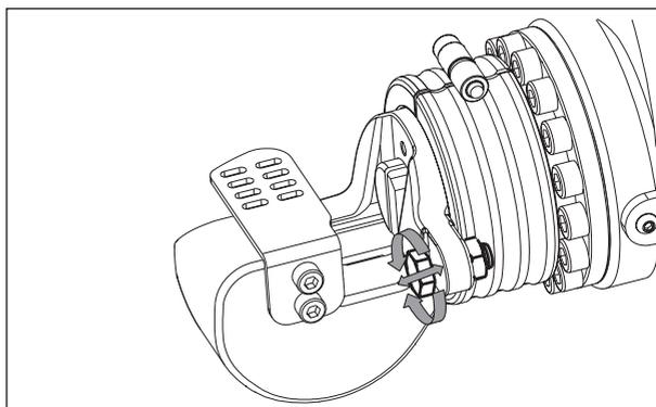
Figura 8, ajuste do parafuso de suporte
