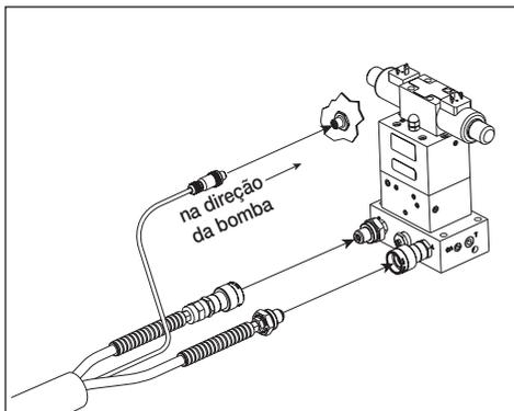
Figura 3, conexões hidráulicas e elétricas na bomba
