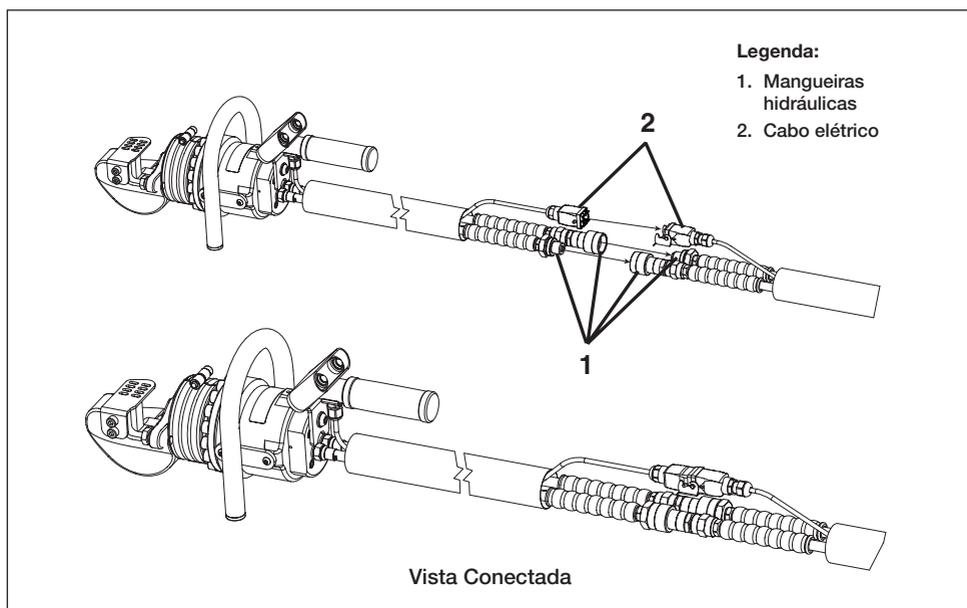
Figura 2, conexões hidráulicas e elétricas no cortador (típicas)
