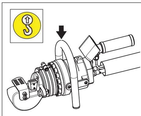
Figura 5, ponto de levantamento do cortador
