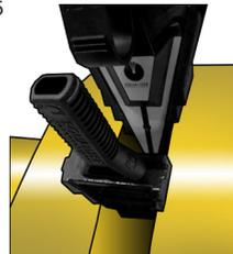
Veiller à ce que toute la largeur de l'étage de bloc de sécurité sélectionné soit totalement insérée avant de rétracter progressivement l'outil jusqu'à ce que la charge de la bride soit appliquée au bloc de sécurité (voir fig. 6).
