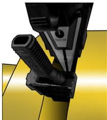
Pour utiliser le plus petit étage du bloc de sécurité, placer l'outil dans la fenêtre et l'activer suffisamment pour décharger les blocs de sécurité. Il est ainsi possible de fermer progressivement le joint à bride.
