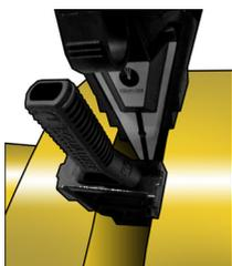
Чтобы использовать ступеньку меньшей ширины, установите инструмент в зазор и разведите его настолько, чтобы предохранительные упоры освободились. Таким образом фланцевое соединение можно постепенно сомкнуть.
