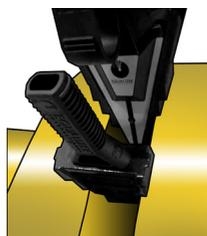
Примите меры к тому, чтобы выбранные предохранительные упоры были вставлены полностью, на всю ширину выбранной ступеньки, и только затем выполните постепенное смыкание инструмента, пока нагрузка от фланца не перенесется на упоры (см. рис. 6).
