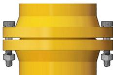
До начала разгонки фланцев необходимо сделать предварительную оценку, чтобы определить самое рациональное положение установки инструментов по окружности соединения. Всегда должны использоваться минимум 2 инструмента (см. рис. 2).
