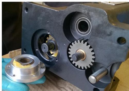
Figura 44: Rimozione del coperchio
