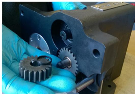
Figura 42: Rimozione dell'ingranaggio
