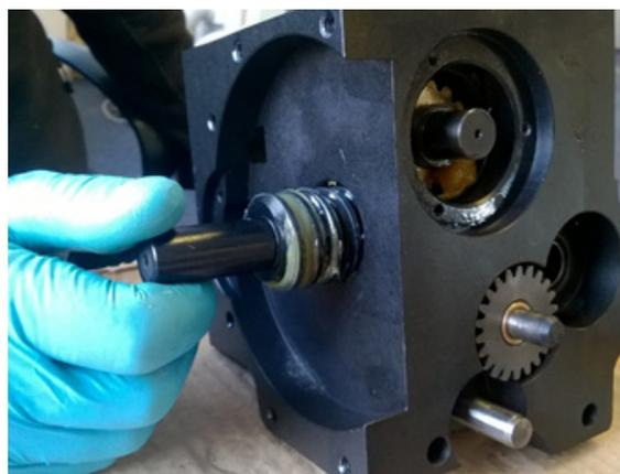
Figura 45: Rimozione della vite senza fine
