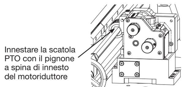
Figura 27: Ingranaggio della scatola della presa di forza
