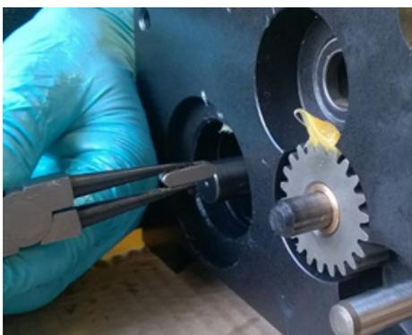
Figura 47: Rimozione della chiave
