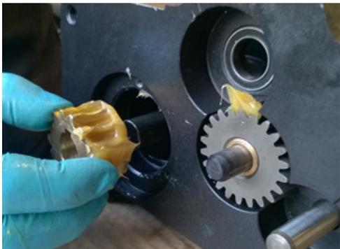
Figura 46: Rimozione dell'ingranaggio
