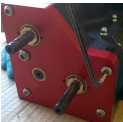
Figura 40: Rimozione della piastra di copertura esterna rossa
