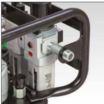
▼ Le cadre de protection soutient et protège le filtre/régulateur/lubrificateur (FRL).
