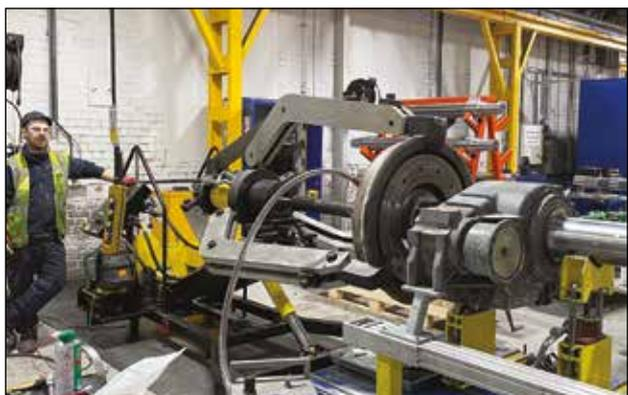
◀ Estrattore LGH3100 utilizzato per rimuovere la ruota della guida dall'asse.
