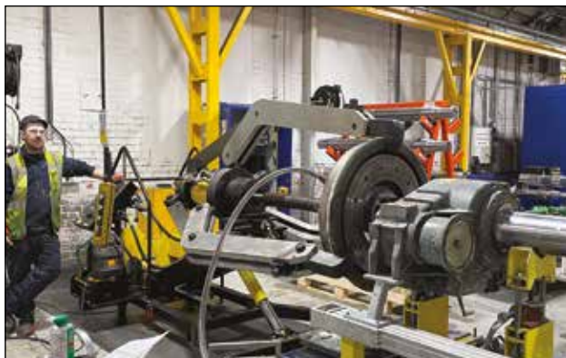
◀ A LGH3100 usada para remover a roda do eixo.
