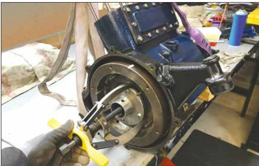
1. La maneta de ajuste facilita la colocación de las garras en la aplicación y aumenta la velocidad de la operación.
