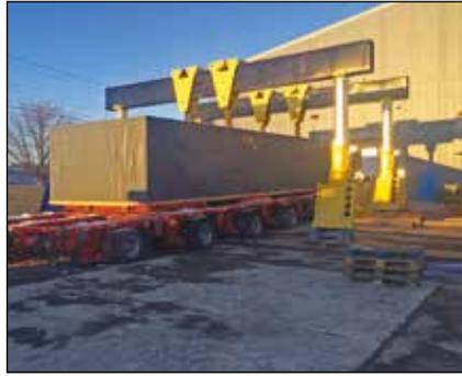
Sicherer Transport eines 120 Tonnen schweren Maschinenunterbaus mithilfe eines hydraulischen Portalkrans
