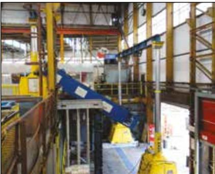
Transport einer 1200 Tonnen schweren Hydraulikpresse in ein Zwischengeschoss mithilfe eines hydraulischen Portalkrans
