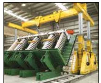
▼ Ein Hubfuß des hydraulischen Mini-Lift-Portalkrans ML40; abgebildet mit kabelloser Fernbedienung
