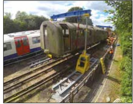
Abtransport von ausrangierten Waggons der Londoner U-Bahn mit einem hydraulischen Portalkran
