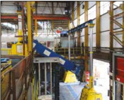
**Transporte de una prensa hidráulica de 1200 toneladas al segundo piso con un pórtico hidráulico**
