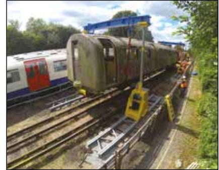
**Retirada de trenes de desmantelamiento del metro de Londres con un pórtico hidráulico**
