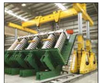
▼ Una pata del pórtico hidráulico Mini-Lift ML40; se muestra con la botonera inalámbrica
