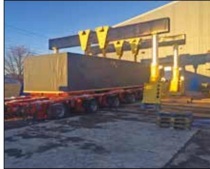
**El pórtico de pluma hidráulico transporta de forma segura el asiento de una máquina de 120 toneladas**
