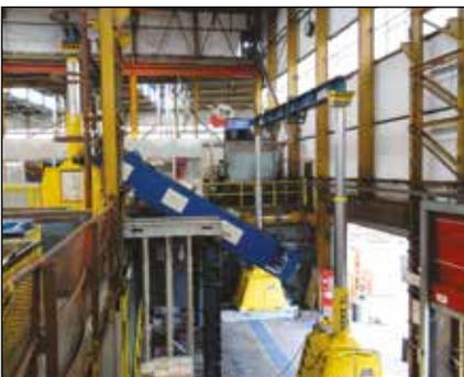
Transport d'une presse hydraulique de 1200 tonnes à l'étage à l'aide d'un portique de manutention hydraulique
