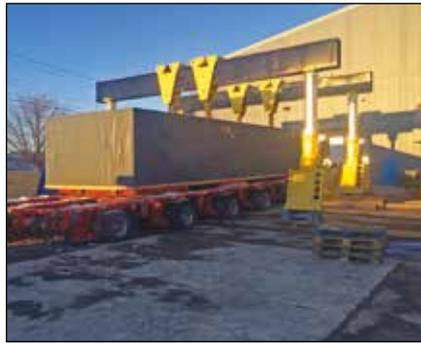
Un portique de manutention hydraulique à éperon transporte en toute sécurité un banc de machine de 120 tonnes
