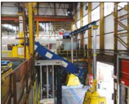
**Trasporto di una pressa idraulica da 1200 tonnellate al secondo piano utilizzando una gru a cavalletto idraulica**
