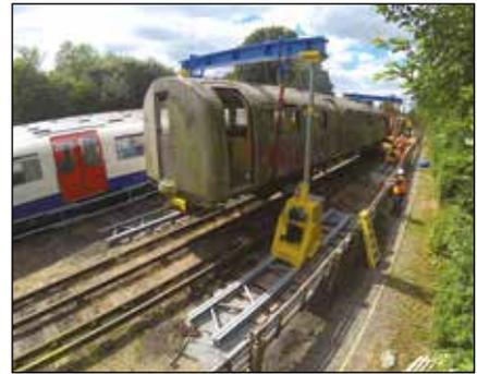
**Smontaggio di treni dismessi della metropolitana di Londra con una gru a cavalletto idraulica**
