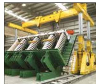
▼ Uma perna do Pórtico Hidráulico Mini-Lift ML40; mostrado com Botoeira Sem Fio
