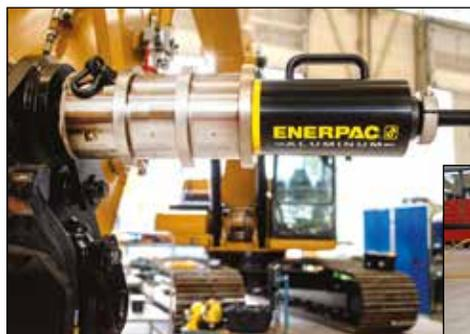
◀ Mantenimiento de excavadoras utilizando la PPH40 impulsada por una bomba inalámbrica serie SC.
