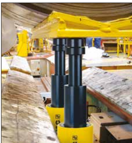
◀ La corsa più lunga dei cilindri telescopici vi permette di risparmiare tempo e di semplificare i lavori grazie allo spostamento del carico su distanze maggiori senza il ricorso a blocchi di supporto temporanei.
