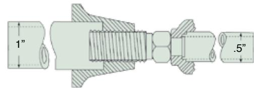
▲ El gato separador puede extenderse fácilmente, colocando una tubería de 5 pulgadas de diámetro en el asiento de la cabeza y una tubería de 1 pulgada de diámetro en el asiento de la carcasa.
