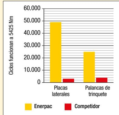
\* *Resultados promedio, donde se probaron tres cassettes UltraSlim de 46 mm de Enerpac y tres cassettes de 46 mm de competidores a 5425 Nm durante 50.000 ciclos. Las placas laterales de Enerpac nunca se rompieron durante la totalidad de duración de la prueba.*
