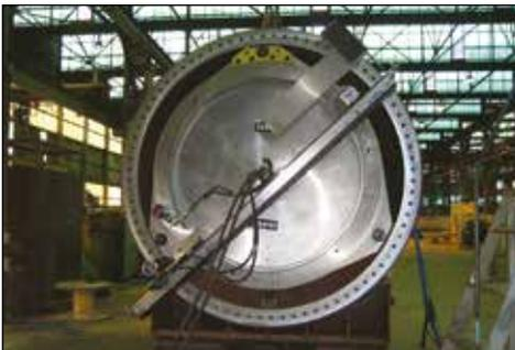
▼ Fresado del extremo del álabes de una turbina con WP3500.
