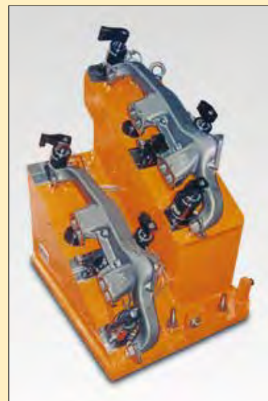
■ Cilindri a staffa rotante MPTL-100 e MPTR-100 Collet-Lok® vengono utilizzati per il serraggio sicuro del collettore di scarico.
