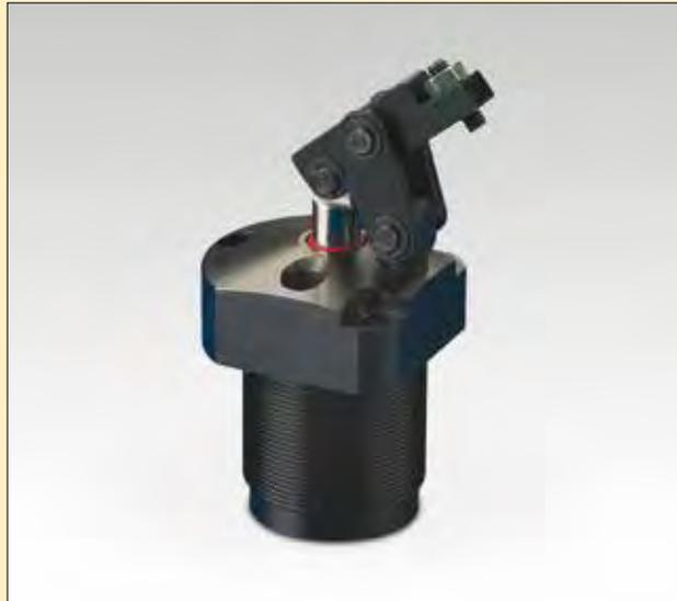
Il link clamp permette il caricamento senza ostruzioni del pezzo in lavorazione e produce alte forze di bloccaggio. I cilindri idraulici si estendono per produrre forza di bloccaggio e si ritraggono per permettere la rimozione del pezzo.
