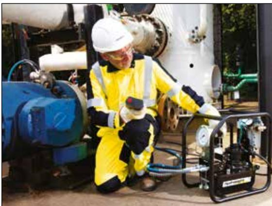
◀ *Hydraulik-Drehmomentschlüssel der gängigsten Marken können mit der Verschraubungspumpe der ZA4T-Serie von Enerpac betrieben werden.*
