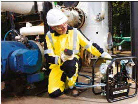
◀ La mayoría de las llaves dinamométricas hidráulicas pueden ser accionadas por bombas para llaves de la serie ZA4T de Enerpac.
