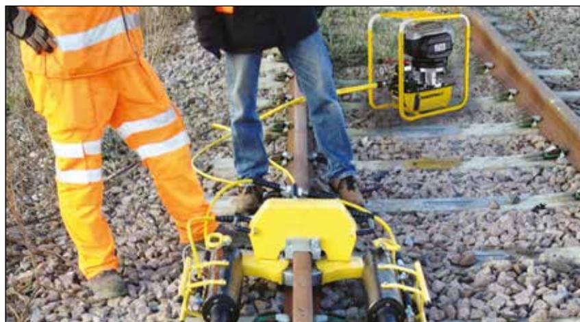
◀ Bomba especial Enerpac série ZC3 usada para aplicações de tensionamento de trilhos.
