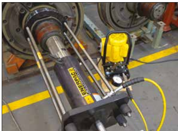
◀ Trazione della ruota della rotaia mediante cilindro in alluminio RACH alimentato dalla pompa della serie ZE.
