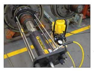
◀ Tração da roda do trilho usando o cilindro de alumínio RACH alimentado pela bomba Série ZE.
